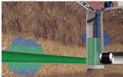
componente SL2 con particelle nano (dimensione 10 nm = 0,00000001 m) per agglomerati silicatici compatti ed omogenei
